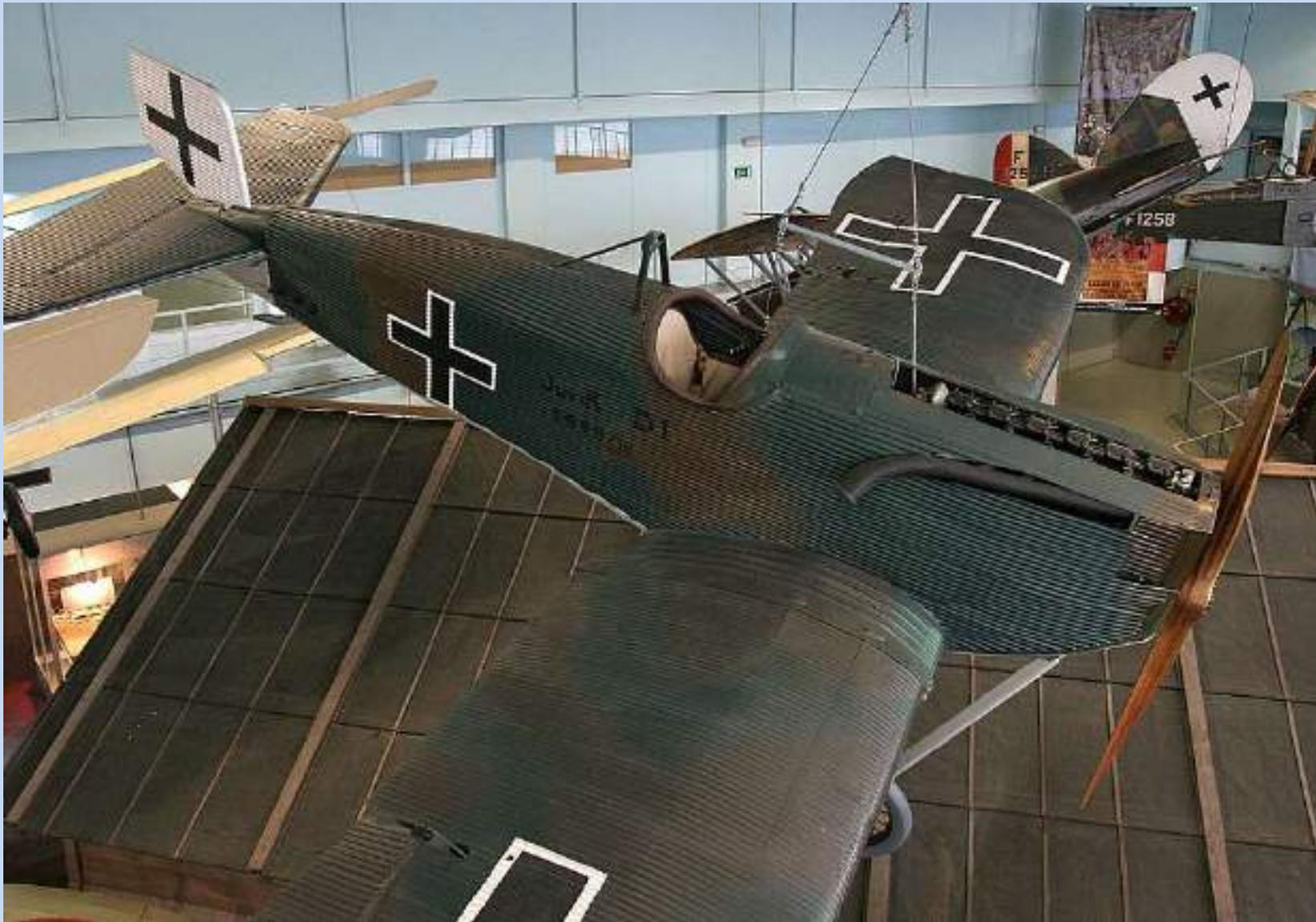
Junkers D.1 – primo aereo completamente metallico, entrato in servizio nell'aprile 1918
